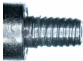
ZERSTÖRT → No-Name Ultraschallinstrumente beanspruchen die Sonotrode und verkürzen die Lebensdauer extrem
